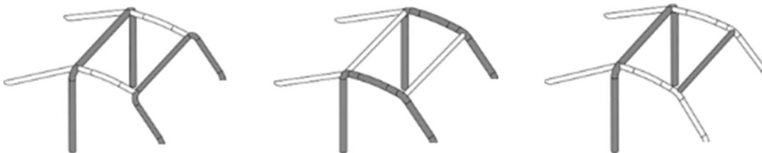
Os tubos (a cinzento) da estrutura escolhida deverá ser em aço carbono sem costura, apenas de perfil circular, com espessuras mínimas de 50x2mm (2.0x0.083 in) ou 45x2,5mm (1.75x0.095 in), e tensão de cedência mínima de 350 MPa (50 kPsi).
