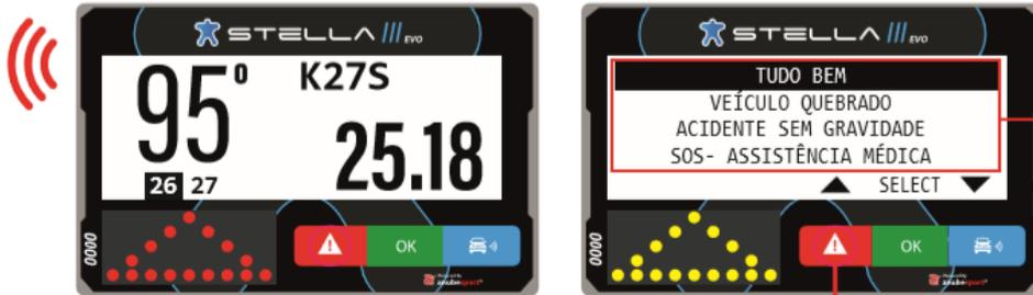
Dentro de uma especial, é ativado automaticamente se o veículo estiver parado por mais de 30 segundos.
